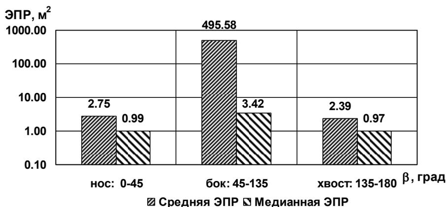
Рис. 3.47. Диаграммы средней и медианной ЭПР в трех диапазонах азимутальных углов при зондировании на горизонтальной поляризации и частоте 1 ГГц (длина волны 30 см)
