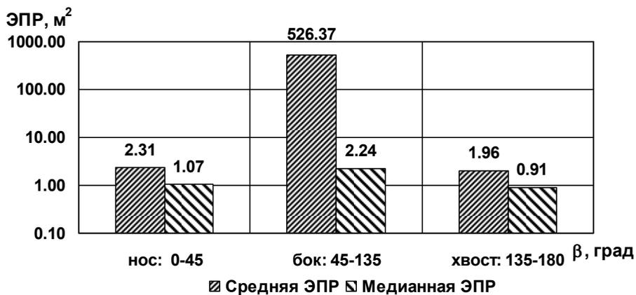
Рис. 3.41. Диаграммы средней и медианной ЭПР в трех диапазонах азимутальных углов при зондировании на горизонтальной поляризации и частоте 3 ГГц (длина волны 10 см)
