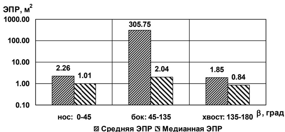
Рис. 3.35. Диаграммы средней и медианной ЭПР в трех диапазонах азимутальных углов при зондировании на горизонтальной поляризации и частоте 10 ГГц (длина волны 3 см)
