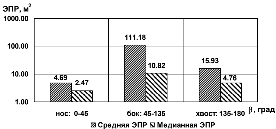
Рис. 3.95. Диаграммы средней и медианной ЭПР в трех диапазонах азимутальных углов при зондировании на частоте 1 ГГц (длина волны 30 см)
