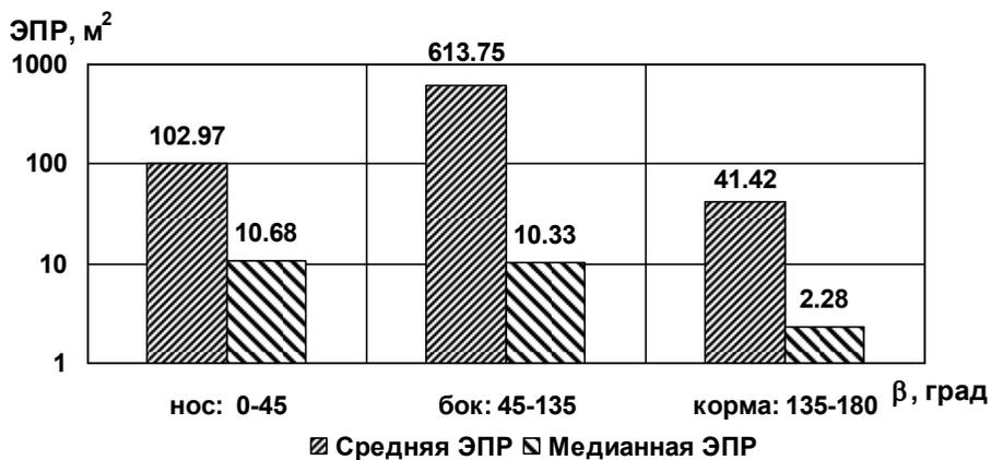
Рис. 3.209. Диаграммы средней и медианной ЭПР в трех диапазонах азимутальных углов при зондировании на горизонтальной поляризации ( $\epsilon = 10^\circ$ , подстилающая поверхность – сухой суглинок)
