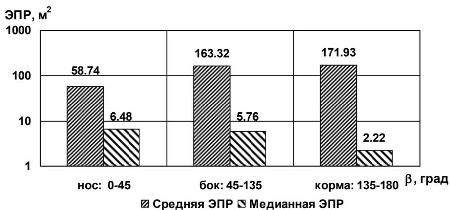
Рис. 3.203. Диаграммы средней и медианной ЭПР в трех диапазонах азимутальных углов при зондировании на горизонтальной поляризации ( $\epsilon = 1^\circ$ , подстилающая поверхность – сухой суглинок)
