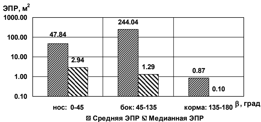
Рис. 3.261. Диаграммы средней и медианной ЭПР в трех диапазонах азимутальных углов при зондировании на горизонтальной поляризации ( \varepsilon = 30^\circ , подстилающая поверхность – сухой суглинок)
