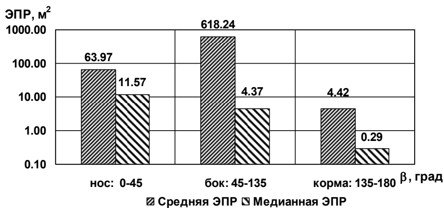
Рис. 3.249. Диаграммы средней и медианной ЭПР в трех диапазонах азимутальных углов при зондировании на горизонтальной поляризации ( \epsilon = 10^\circ , подстилающая поверхность – сухой суглинок)
