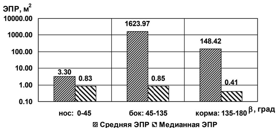
Рис. 3.307. Диаграммы средней и медианной ЭПР в трех диапазонах азимутальных углов при зондировании на горизонтальной поляризации ( $\varepsilon = 30^\circ$ , подстилающая поверхность – влажный суглинок)
