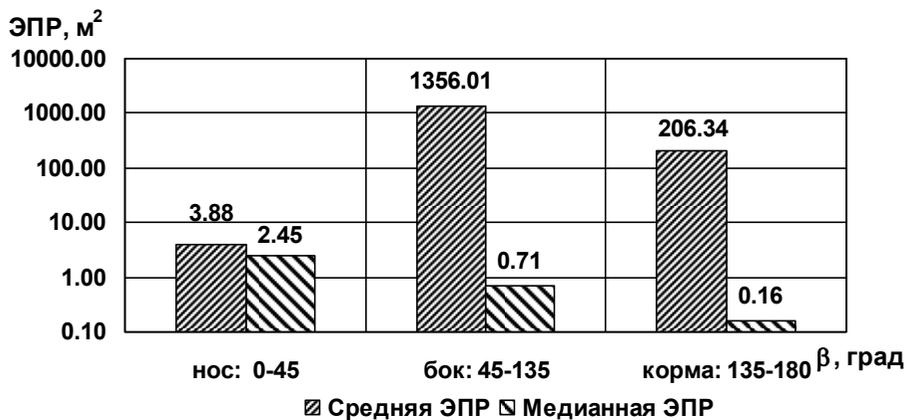
Рис. 3.289. Диаграммы средней и медианной ЭПР в трех диапазонах азимутальных углов при зондировании на горизонтальной поляризации ( $\varepsilon = 10^\circ$ , подстилающая поверхность – сухой суглинок)
