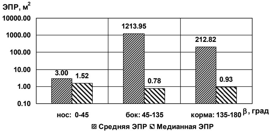
Рис. 3.284. Диаграммы средней и медианной ЭПР в трех диапазонах азимутальных углов при зондировании на вертикальной поляризации ( $\epsilon = 1^\circ$ , подстилающая поверхность – сухой суглинок)
