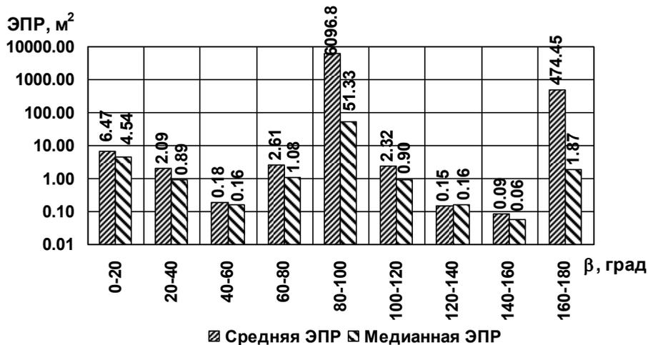
Рис. 3.291. Диаграммы средней и медианной ЭПР в двадцатиградусных диапазонах азимута при зондировании на горизонтальной поляризации ( $\epsilon = 10^\circ$ , подстилающая поверхность – сухой суглинок)
