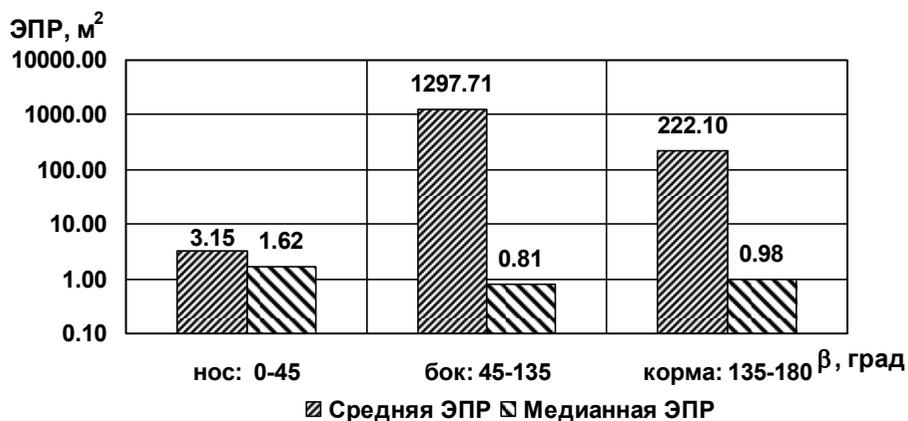
Рис. 3.283. Диаграммы средней и медианной ЭПР в трех диапазонах азимутальных углов при зондировании на горизонтальной поляризации ( $\varepsilon = 1^\circ$ , подстилающая поверхность – сухой суглинок)
