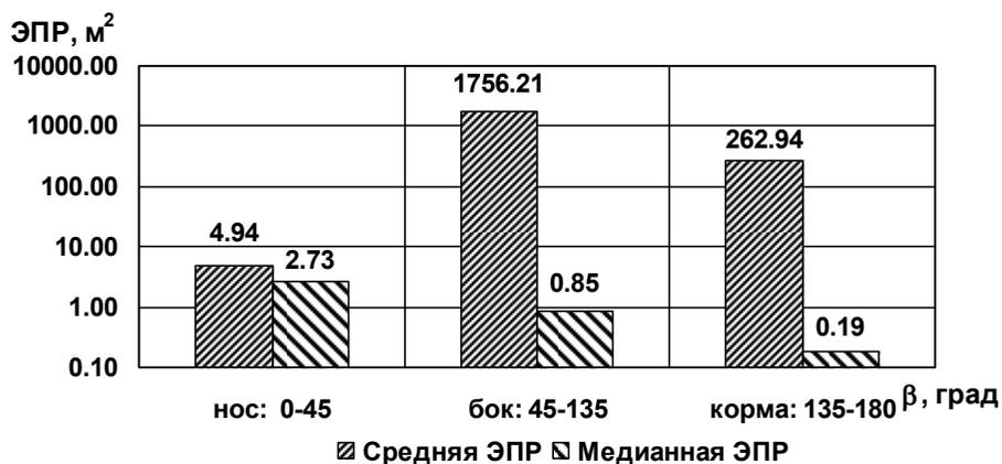
Рис. 3.295. Диаграммы средней и медианной ЭПР в трех диапазонах азимутальных углов при зондировании на горизонтальной поляризации ( $\varepsilon = 10^\circ$ , подстилающая поверхность – влажный суглинок)
