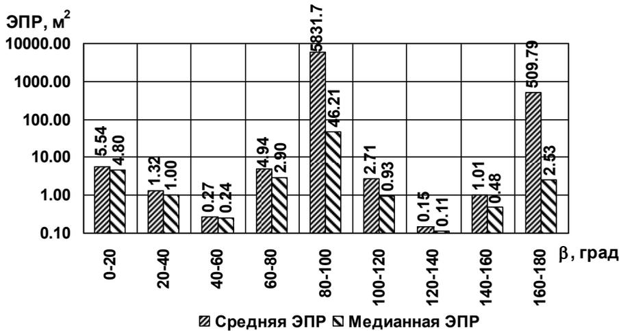
Рис. 3.285. Диаграммы средней и медианной ЭПР в двадцатиградусных диапазонах азимута при зондировании на горизонтальной поляризации ( $\epsilon = 1^\circ$ , подстилающая поверхность – сухой суглинок)
