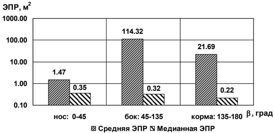
Рис. 3.296. Диаграммы средней и медианной ЭПР в трех диапазонах азимутальных углов при зондировании на вертикальной поляризации ( $\epsilon = 10^\circ$ , подстилающая поверхность – влажный суглинок)
