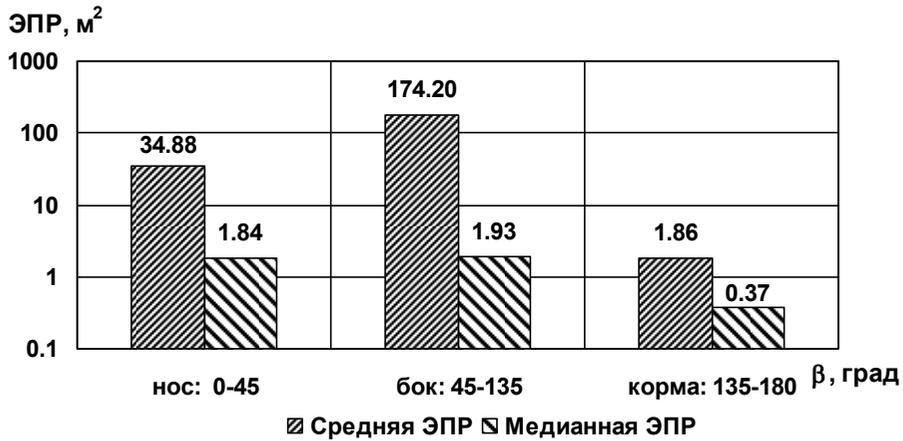
Рис. 3.228. Диаграммы средней и медианной ЭПР в трех диапазонах азимутальных углов при зондировании на вертикальной поляризации ( $\epsilon = 30^\circ$ , подстилающая поверхность – влажный суглинок)
