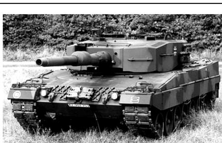
Рис. 3.240. Основной боевой танк Leopard-2A4
