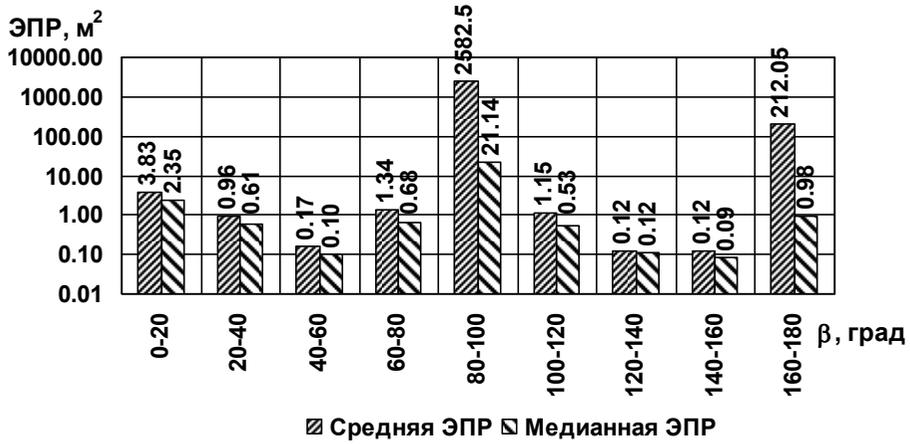
Рис. 3.292. Диаграммы средней и медианной ЭПР в двадцатиградусных диапазонах азимута при зондировании на вертикальной поляризации ( $\epsilon = 10^\circ$ , подстилающая поверхность – сухой суглинок)
