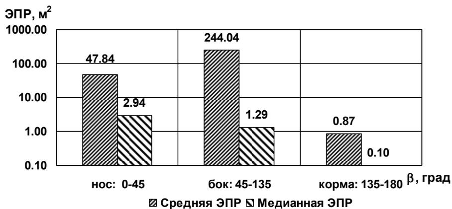
Рис. 3.261. Диаграммы средней и медианной ЭПР в трех диапазонах азимутальных углов при зондировании на горизонтальной поляризации ( $\epsilon = 30^\circ$ , подстилающая поверхность – сухой суглинок)
