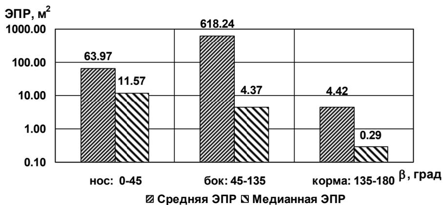
Рис. 3.249. Диаграммы средней и медианной ЭПР в трех диапазонах азимутальных углов при зондировании на горизонтальной поляризации ( $\varepsilon = 10^\circ$ , подстилающая поверхность – сухой суглинок)
