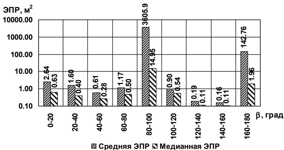
Рис. 3.303. Диаграммы средней и медианной ЭПР в двадцати-градусных диапазонах азимута при зондировании на горизонтальной поляризации ( $\varepsilon = 30^\circ$ , подстилающая поверхность – сухой суглинок)
