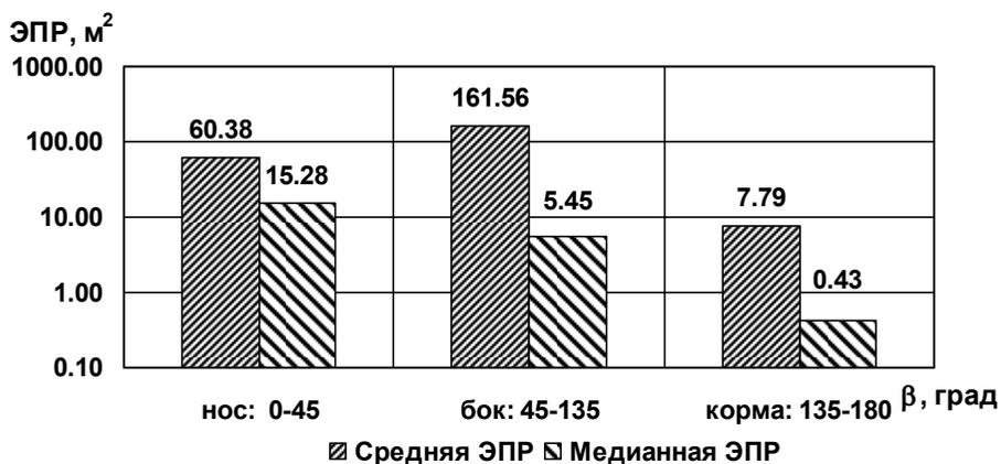
Рис. 3.255. Диаграммы средней и медианной ЭПР в трех диапазонах азимутальных углов при зондировании на горизонтальной поляризации ( $\epsilon = 10^\circ$ , подстилающая поверхность – влажный суглинок)
