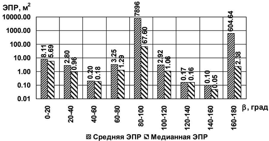
Рис. 3.297. Диаграммы средней и медианной ЭПР в двадцатиградусных диапазонах азимута при зондировании на горизонтальной поляризации ( $\epsilon = 10^\circ$ , подстилающая поверхность – влажный суглинок)
